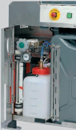
**Flujómetro** con llave esférica de dosificación del Fontan Mobilstar M. Depósito de limpieza y depósito de combustible con indicación de nivel.
