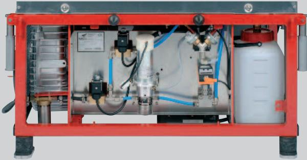
**Transporte de la preparación química** en los aparatos Fontan Mobilstar E y ER a través de una bomba de engranajes en acero inoxidable resistente a productos químicos. La cantidad transportada se logra mediante la regulación electrónica de las revoluciones.
