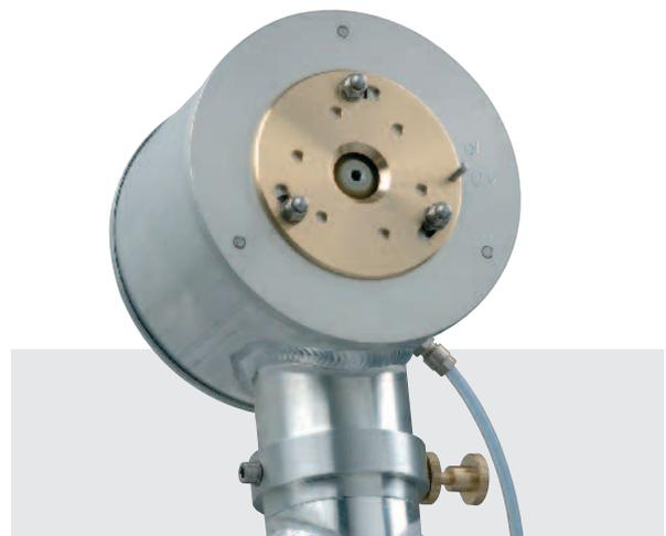
**Cabezal de nebulización** del Fontan Mobilstar, con contraplaca para ULV y LV. En la posición "LV" la cantidad de aire es reducida en la boca de salida de la niebla, para la producción de gotas más grandes.
